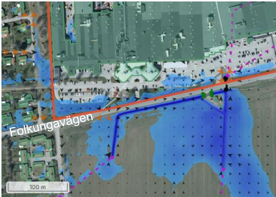
Figur 3. Närbild av figur 1 i fabriksområdets sydvästra del. Pilarna visar flödesriktning och översvämning över 10 cm vid regnets maximum.
