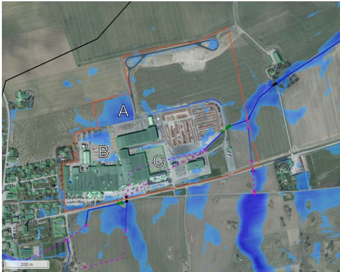
Figur 2. Skyfallsanalys av ett klimatanpassat 100-årsregn (år 2100) gjord i Scalgo Live Dynamic Flood. Vattendjup över 10 cm vid maximal vattennivå visas. Hänvisningar till bokstäver görs i texten nedan. Rosa och gröna sträckningar indikerar kultivertar i modellen och gröna ytor är taktytor. Vid C har tak lagts in i modellen i enlighet med verklig situation.
