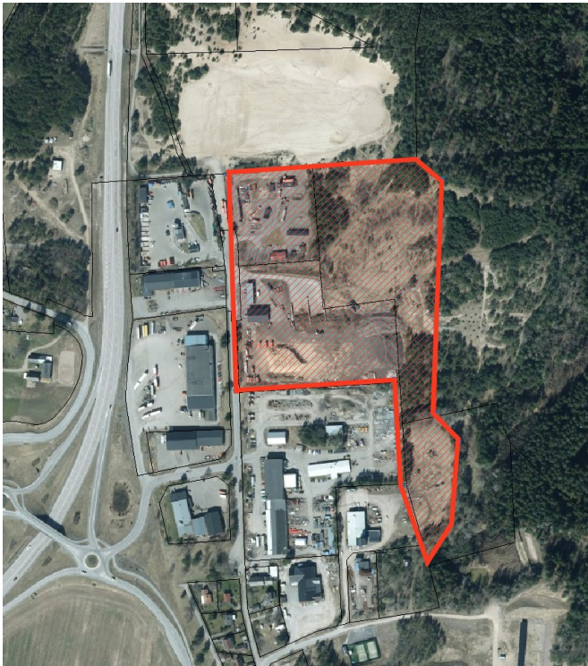
Figur 8. Rödmarkerad, skrafferad yta visar område där okontrollerade fyllnadsmassor med varierande stabilitet förekommer.
