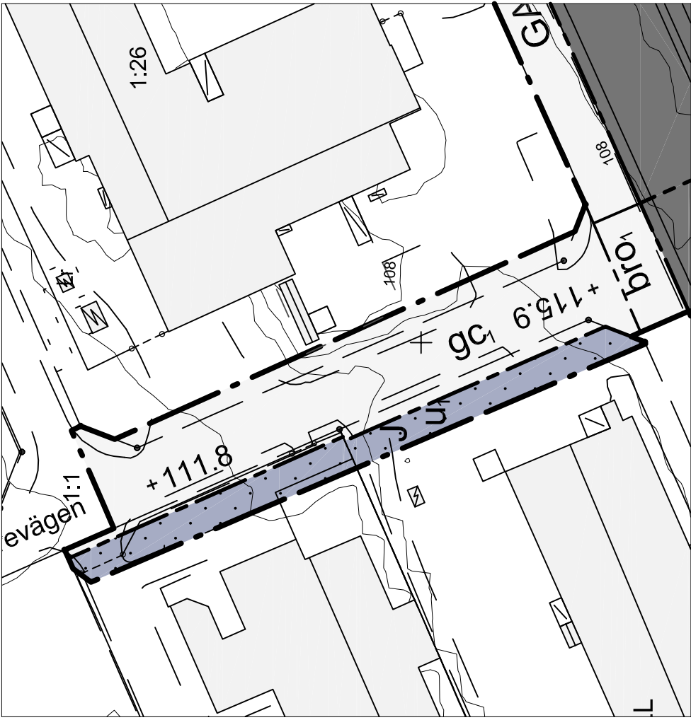
DELFÖRSTÖRING - Brorrampens utrymmesbehov Skala 1:1000
