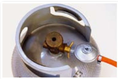
Gasolbehållare med monterad reducer-ventil
