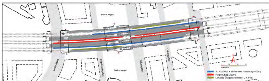
Figur 21 Princip för plattformar. Flera gator föreslås kunna passera under spåren och ha entré till stationsbyggnaden. Runt stationen kan Linköpings kommun planera för nya stadskvarter. Streckade linjer visar schematiskt hur kvarter skulle kunna tillkomma.
