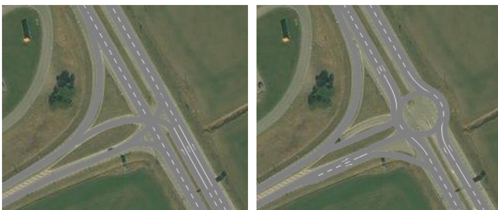
Figur 7. Korsning Västerlösavägen/väg 638. Dagens utformning till vänster och cirkulationsplats till höger.
