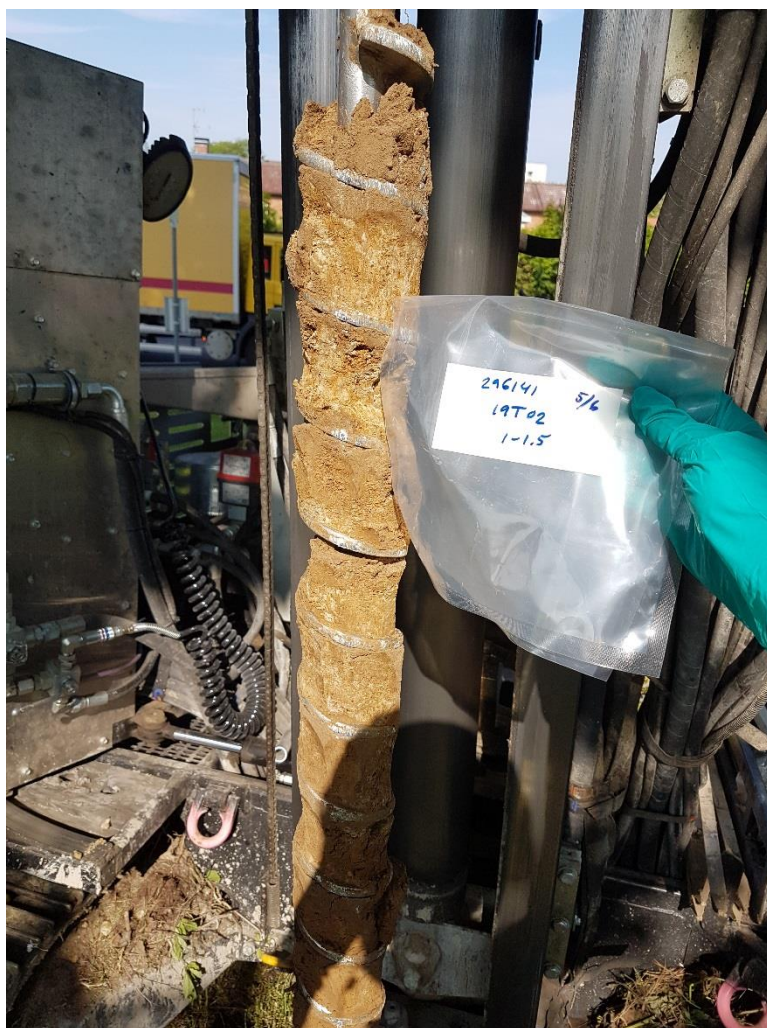
19T02. Skruvprovtagning på nivå 1–2 m.
