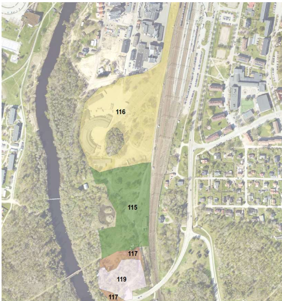
Figur 8. De planerade marknivåer som föreliggande utredning utgått ifrån. Siffrorna anger meter över havet.
