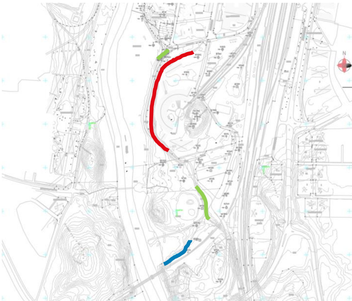
Figur 3 Översiktskarta med instabila slänter markerade med röda och blå linjer.
