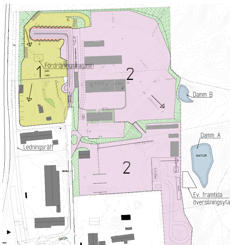
Figur 22. Delområden för avledning av dagvatten efter exploatering (VOS, 2025).
