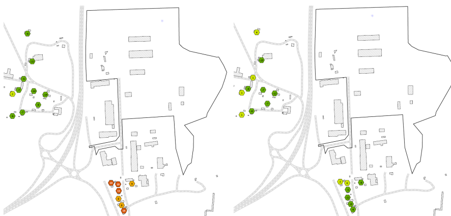
Figur 15. Skillnad i ekvivalent ljudnivå för krossning mellan utbyggnadsalternativet och nuläget. T.v. inerta material. T.h. returträ.
