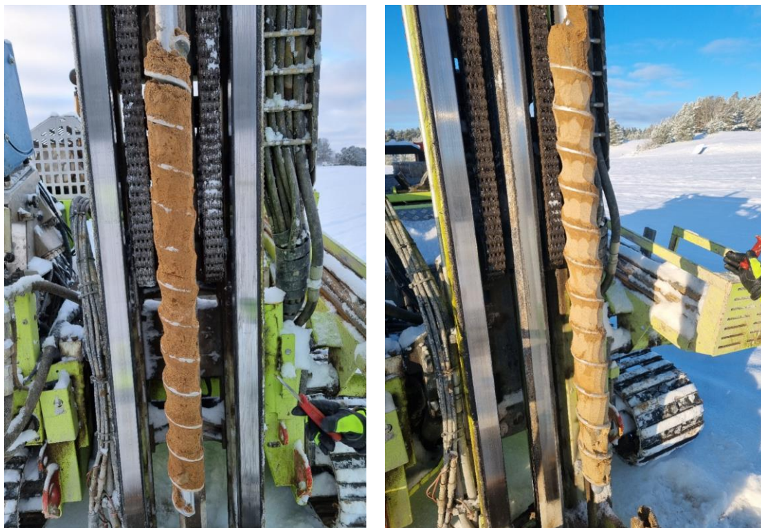
Figur 6. Exempel på skruvar vid jordprovtagning. 23T403 0-1 m u my (Jordartsbedömning: grusig, finsandig silt) till vänster och 23T404 3-4 m u my (Jordartsbedömning: siltig finsand) till höger.
