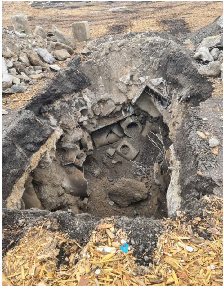
Figur 2. Foto över provgrop 1B. Heterogena fyllnadsmassor. Halter av alifater >C16-C35 uppmättes över MKM i fyllnadsmassorna.
