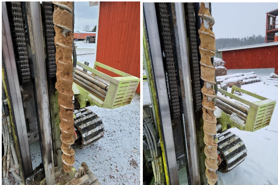
Figur 9. Till vänster: 23T213 0-1 meter (prov uttaget 0-0,7 meter under markytan). Fyllnadsmaterial bestående av grus och sand. Till höger: 23T204 2-3 meter (prov uttaget 2-2,5 meter under markytan). Finsand och silt.
