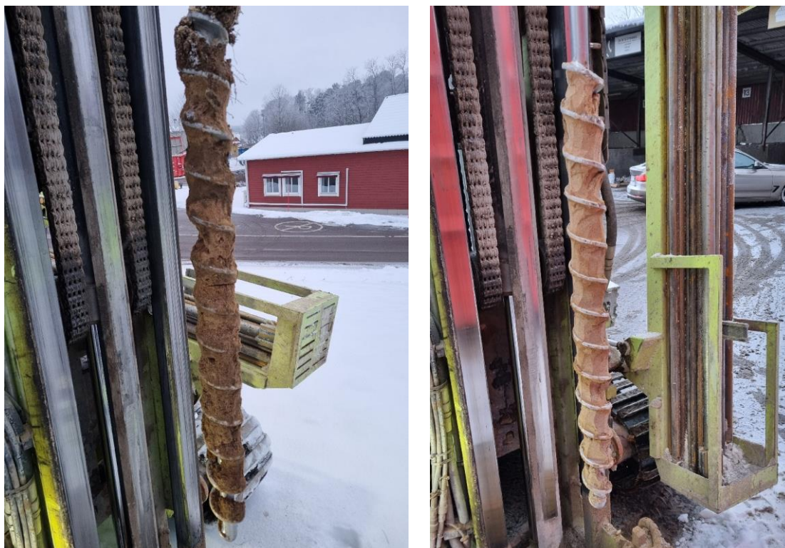
Figur 6. Exempel på skruvar vid jordprovtagning. 23T105 0-0,4 m u my (jordartsbedömning: fyllnadsmaterial, mull och sand) till vänster och 23T101 2-2,5 m u my (jordartsbedömning: bedömt naturligt avsatt jordlager, finsand) till höger.
