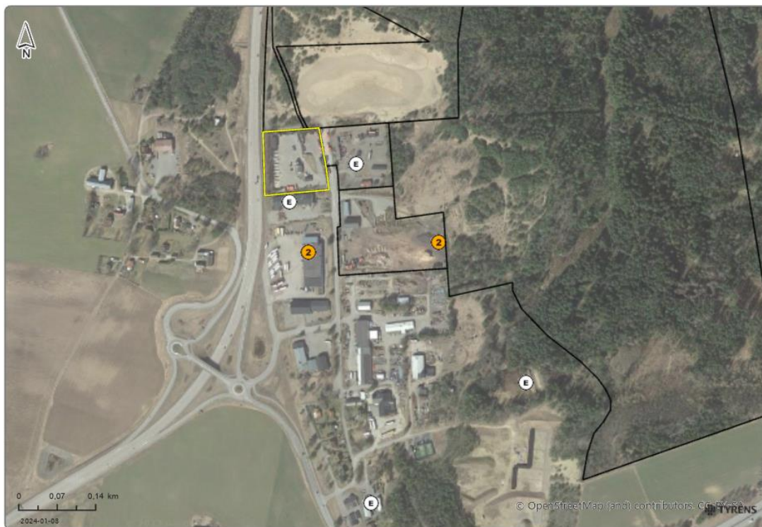
Figur 2. Redovisning av potentiellt förorenade objekt inom och i undersökningsområdets närhet. Klass 2 (orange färg) visar två objekt med stor risk och E (vit färg) visar fyra objekt som ej riskklassats. Undersökningsområdet är markerat i gult.
