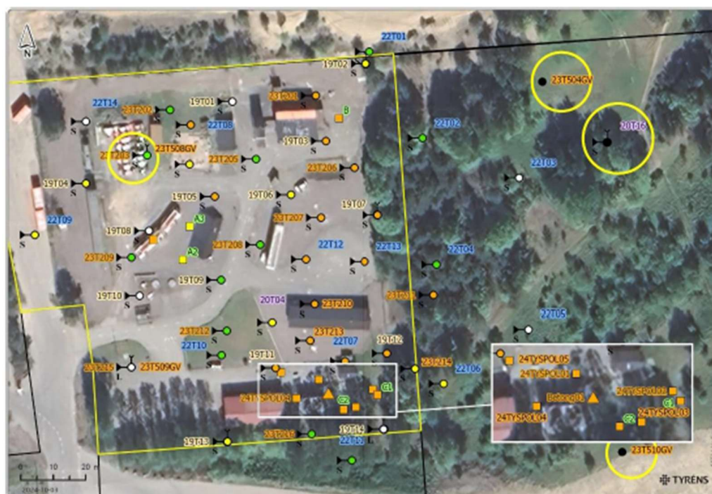
Figur 13. Grundvattenrör i vilka PFAS har påträffats i halter överskridande riktvärdesnivåer inom ramen för nu utförd undersökning år 2023 är inringade i gult. I rör 20T16 har det i tidigare undersökningar påträffats liknande PFAS-halter som i föreliggande utredning. (Tyréns, 2024)
